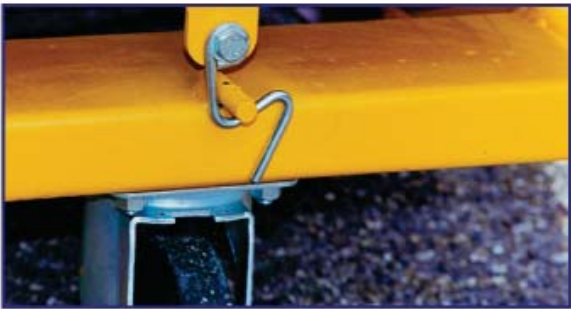
Crochet de sécurité pour verrouiller l'ensemble bac-châssis
