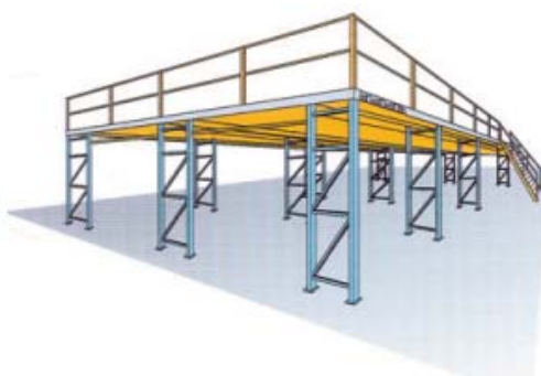
Principe de plate-formes à échelles pour monter d'un niveau et doubler les surfaces.
